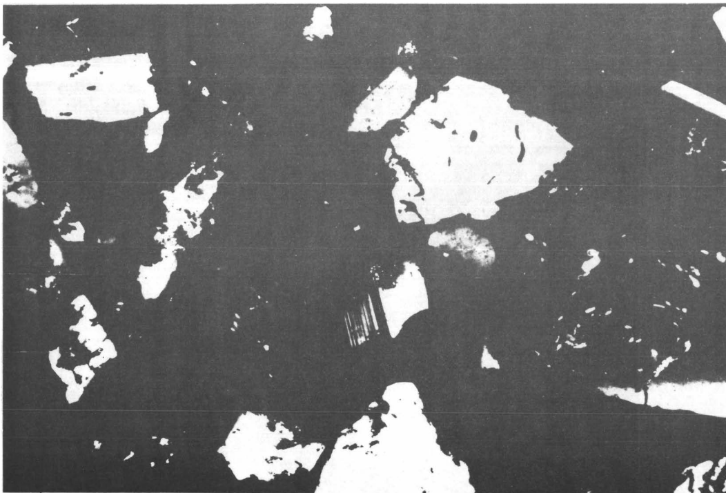
Abb.4: Albite in Glas z.T. angeschmolzen (Bildmitte).Ca.10x; N X).
