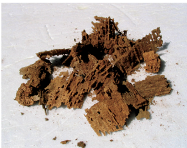
Fig. 6: Eichen-Stirnholz: zu Bohrmehl verarbeitetes Holz
