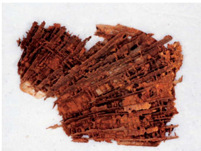
Fig. 7: Eichen-Stirnholz: Markstrahlenskelett als Rest
