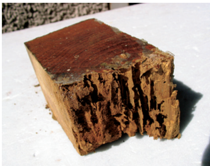
Fig. 5: Eichen-Stirnholz: Holzblock mit Fraßschäden
