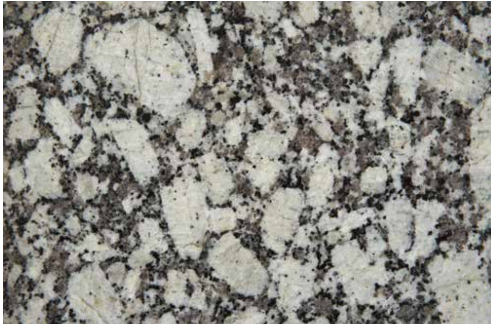
ABB. 10: Polierter Weinsberger Granit, der aus großen Feldspäten (helle Minerale), kleinen Quarzkristallen (grau) und dunklen Glimmern (Biotit) besteht
