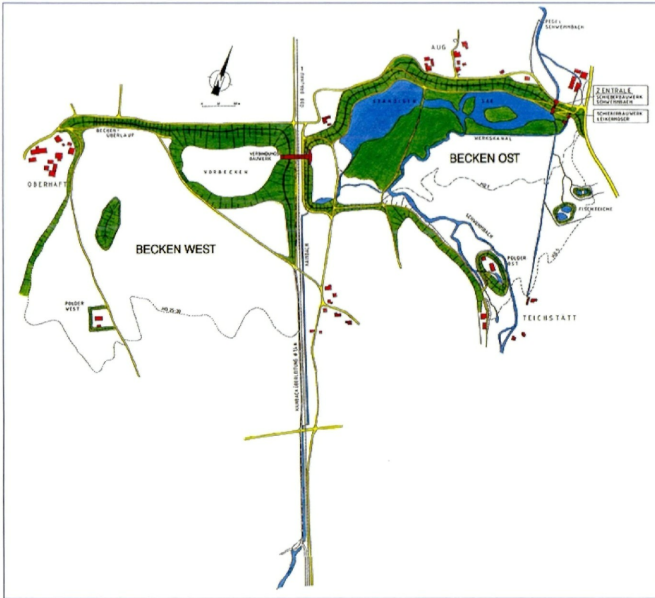
Abb. 15: Übersichtsplan des Rückhaltebeckens Teichstätt.
