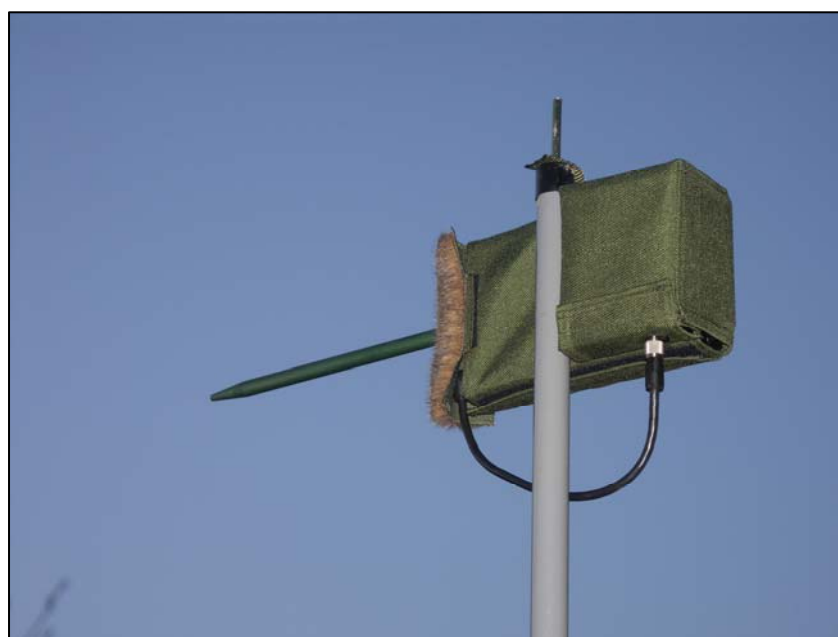
Abb. 3 Automatische Registriereinheit („batcorder“, ecoObs, Nürnberg).
