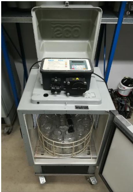
Abbildung 12: ISCO 3700 Ereignis-Probennehmer mit Steuereinheit und Kühlraum
