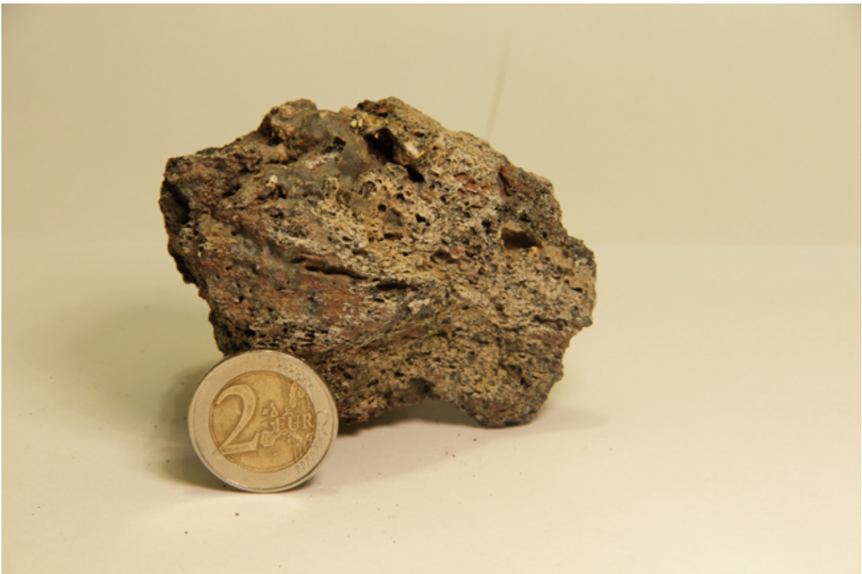
Abb. 5: Das Foto zeigt ein typisches Gesteinsbruchstück, das Egger (1909) sehr treffend als verschlackten Stein bzw. Schlackenstein bezeichnet hat. Die hohe Porosität ist bereits im Handstück deutlich erkennbar.
