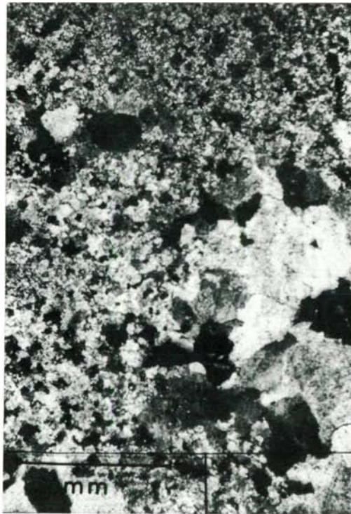
Abb. 10: Dünnschliffbild der Probe PW 6 (mittelostalpinen Dolomit), + Nicols
