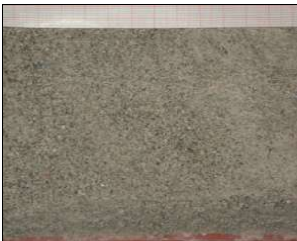
Abb. 3: Sov-1, 46,2-47,2, Industrieschlamm mit feinsandigem Habitus
