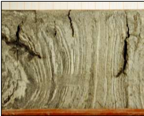
Abb. 5: Sov-2, 87-89 m, Industrieschlamm: schlackenarme (weiß) und reich an Schlacke (schwarz)
