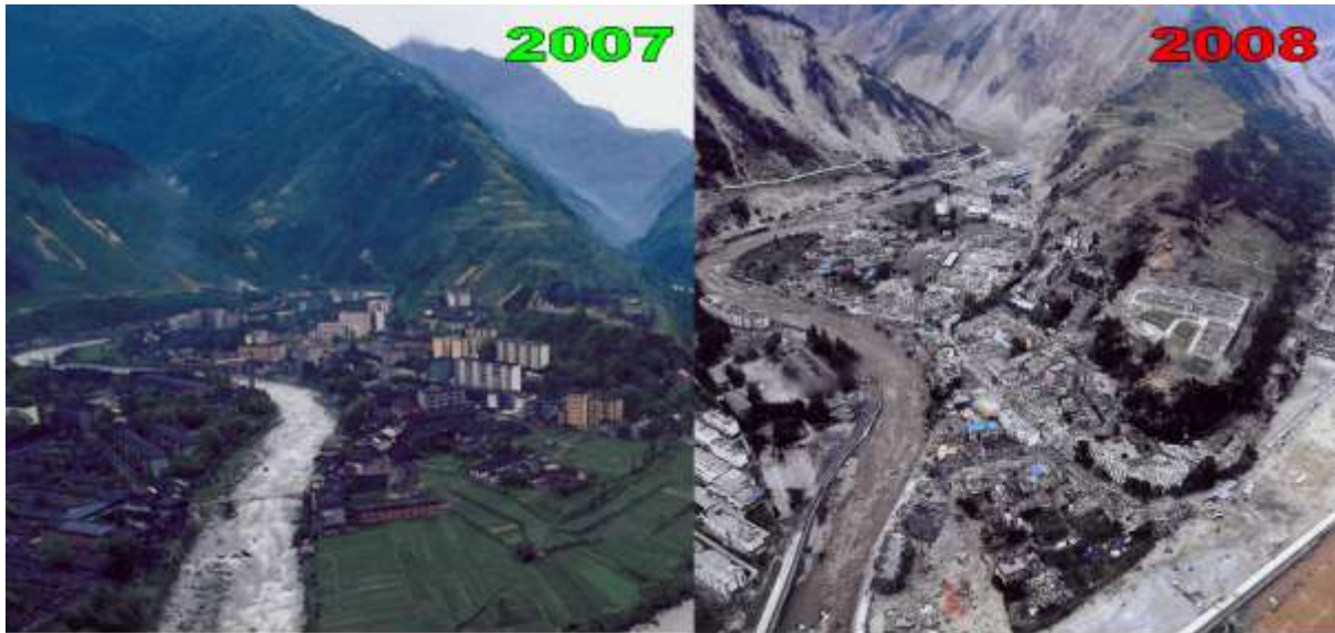
Abb. 3: In Ying Xiu, der Hauptstadt des Bezirks Wenchuan, wurden 90% der Häuser zerstört. Die Bilder vor (links) und nach (rechts) dem Erdbeben vom 12.5.2008 zeigen auch die zahlreichen Veränderungen in der Landschaft in Form von Felsstürzen und Rutschungen.
