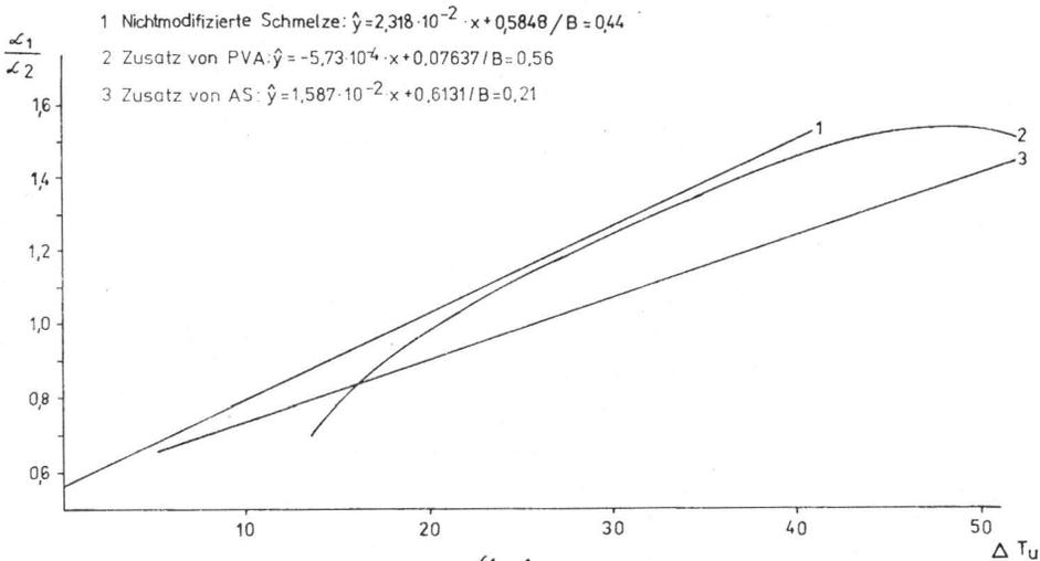
Abb. 4 Abhängigkeit des Verhältnisses  $\frac{\alpha_1}{\alpha_2} (\hat{y})$  von der Unterkühlung  $\Delta T_U (x)$
