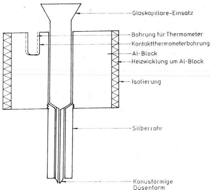
Abb. 1. Schematische Darstellung der Schmelzapparatur
