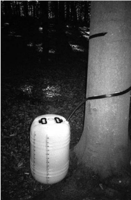
Abb. 4 Stammablaufsammler. Waldtestfläche zur Überwachung der Niederschlagstransformation. Einzugsgebiet des Gardno-Sees.
