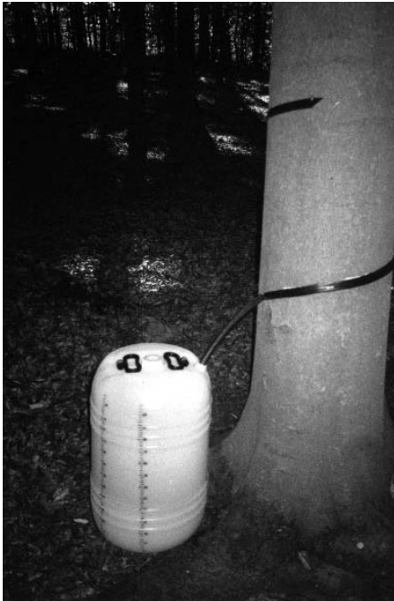
Abb. 4 Stammablaufsammler. Waldtestfläche zur Überwachung der Niederschlagstransformation. Einzugsgebiet des Gardno-Sees.
