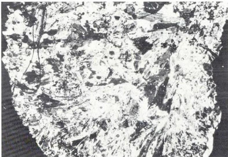
Abb. 10: Dünnschliff durch einen Wandsinter aus den Abb. 8 und 9, gekreuzte Polarisatoren, Bildausschnitt ca. 1 x 0,7 cm.
