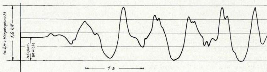
Abb. 3: Jümarsteigen mit der Raupenmethode: Kraft-Zeit-Diagramm
