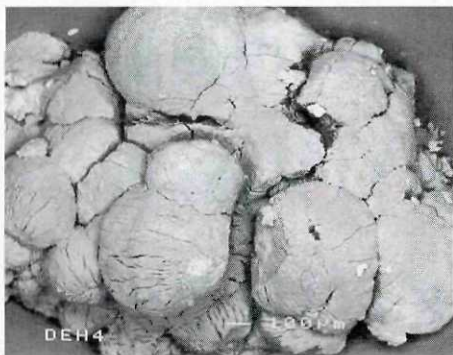
Abb. 8: REM-Aufnahme eines kugelig, nierenförmigen Hydromagnesitaggregates aus dem König Artusdom. Die winzigen Hydromagnesitplättchen dieser primären Generation („Typ I“) stehen senkrecht zur Oberfläche und sind zumeist radial angeordnet. Die feinen Schrumprisse sind Folgen der Austrocknung, z.T. bereits in der Höhle, z.T. durch die untersuchungsbedingten Behandlungen im Hochvakuum. Bildbreite: 1,2 \text{ mm} .
