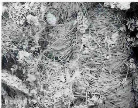
Abb. 9: REM-Aufnahme der Oberfläche eines Hydromagnesitaggregates („Typ I“) aus dem König Artusdom der Eishöhle. Deutlich sind die senkrecht zur Oberfläche stehenden Hydromagnesitplättchen zu sehen. An der Oberfläche des Aggregates befindet sich ein feines Netzwerk sekundärer Bergmilch (Calcit). Bildbreite: 0,2 \text{ mm} .
