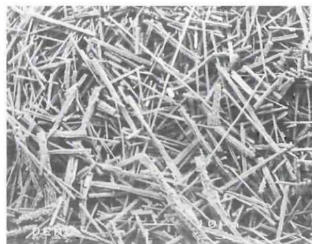
Abb. 7: REM-Aufnahme einer Bergmilchwatte aus der Iwanhalle der Eishöhle. Die wasserärmere Subvarietät weist geradlinige Calcitkristallnadeln mit Durchmesser zwischen 1 - 5 \mu\text{m} auf. An der Oberfläche der Whiskers sind bereits wachstumsbedingte Kristallformen sowie Bündelungen und Verwindungen zu erkennen. Präparationsbedingt sind die Calcitnadeln stark zerbrochen.
