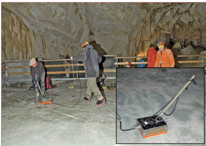
Abb. 3: Georadar-Messung im kontinuierlichen Modus entlang des Längsprofils im Tristandom (Rieseneishöhle). Das kleine Bild zeigt die geschirmte 500 MHz Antenne mit Verbindungskabel und Steuerungsvorrichtung für Aufnahme und Markierung am Handgriff.
