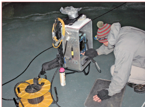
Abb. 2: Das Bild zeigt die in einem speziell angefertigten Tragegestell montierte Georadar-Apparatur GSSI-SIR-2 und das Verbindungskabel zur Antenne. Foto: H. Hausmann
