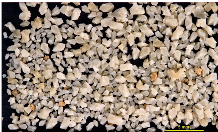
Abb. 5: Kristallsand aus rhomboedrischen Calcitkristallen von Lokalität 1. Crystal sand consisting of rhombohedral calcite crystals from Location 1.
