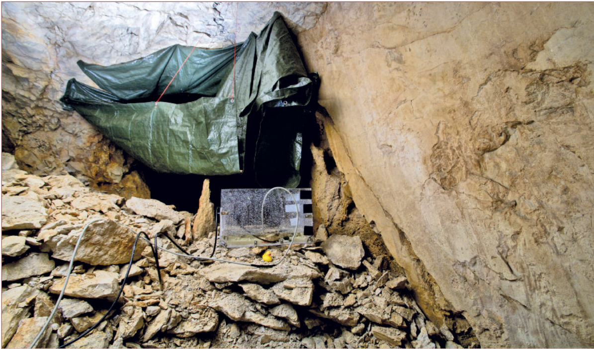
Abb. 5: Das 0,5 m lange Messwehr und Wasserfassung mittels Planen in der Höhle.
