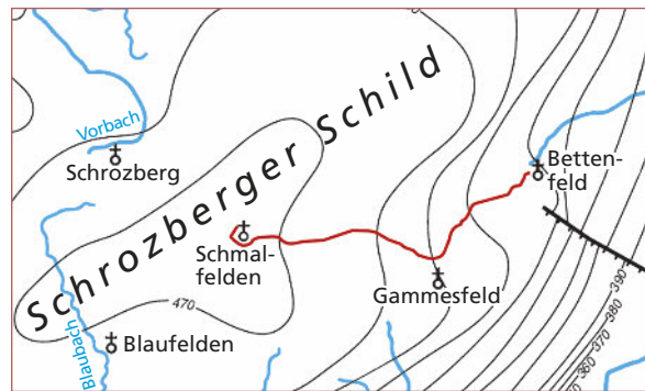
Abb. 2: Höhenkarte der Grenze Oberer Muschelkalk zu Unterkeuper in Meter über Meeresspiegel. Verlauf des Wassergangs in Rot. Verändert nach Zander (1973). Fig. 2: Topography of the transition between Upper Muschelkalk and the Lower Keuper above it. The active passage of Fuchslabyrinth is shown in red. Modified after Zander (1973).
