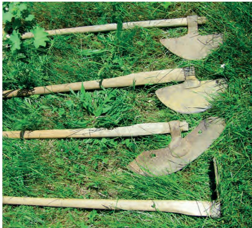
Grabenwerkzeuge: verschiedene Hacken und Wasseräxte zum Verschließen, Einstauen und Putzen der Gräben.
