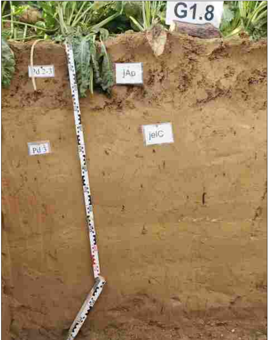
Abbildung 12: Auftragsboden aus Rohlöss mit sehr geringen Humusgehalten im Ober- und Unterboden; Foto: T. Vorderbrügge.
