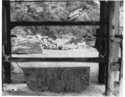
Abb. 9 Unter einer maschinell betriebenen Säge von einfachster Konstruktion liegt ein schon teilweise beschnittener Tuffstein
