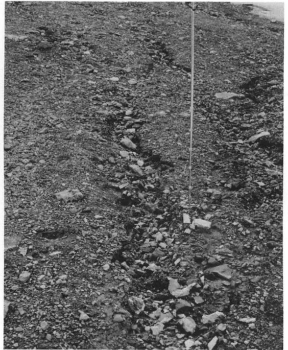
Bild 14 Das Bild zeigt eine Rinnenspülung mit einer durchschnittlichen Eintiefung von 8–10 cm und linienhaftem Abtrag. Deutlich wird, daß in erster Linie Material kleiner Korngröße abgeschwemmt wird. Bei längerem, stetigem Oberflächenabfluß entwickelt sich hier Tiefenerosion. (Bierenwangpiste)
