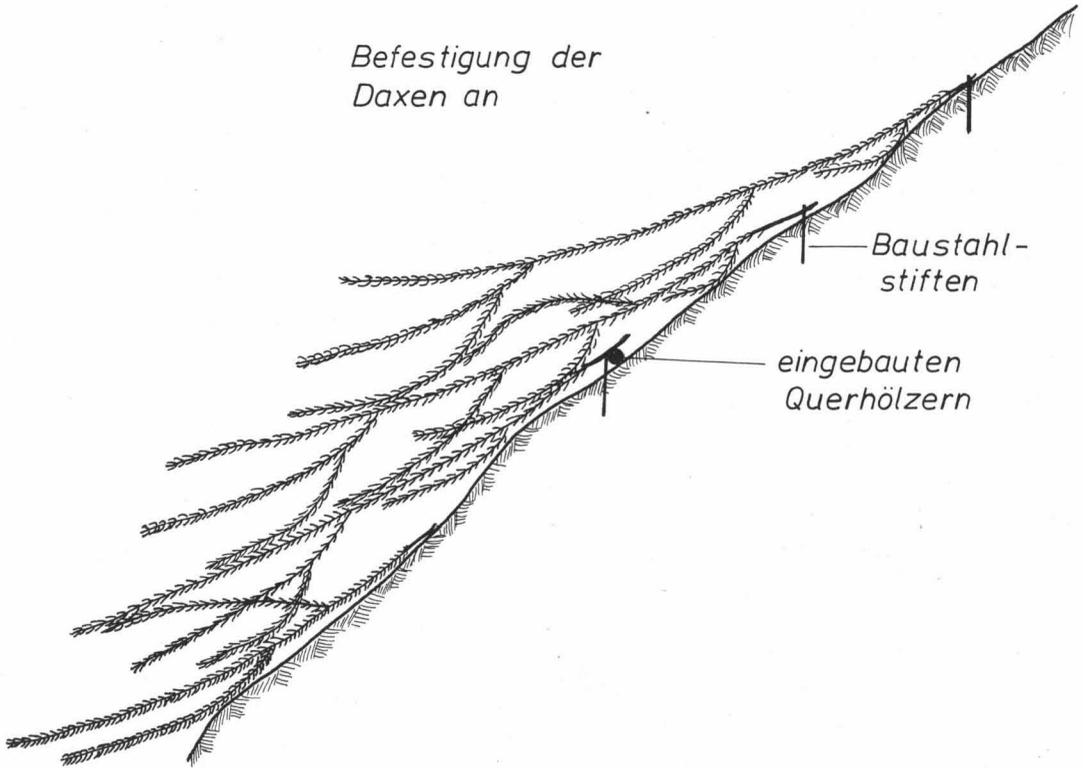
Abb. 5: Schematische Darstellung des Ausdaxens von Erosionsrinnen.
