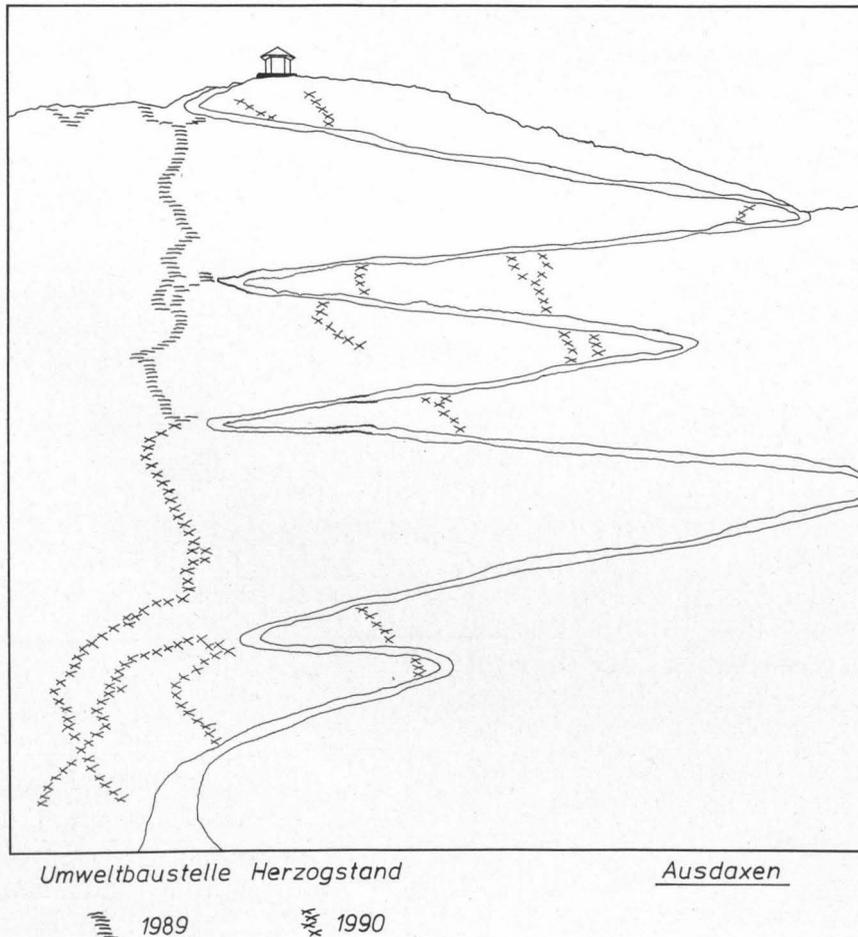
Abb. 6: Zeitliche Abfolge des Ausdaxens der einzelnen Erosionsrinnen.
