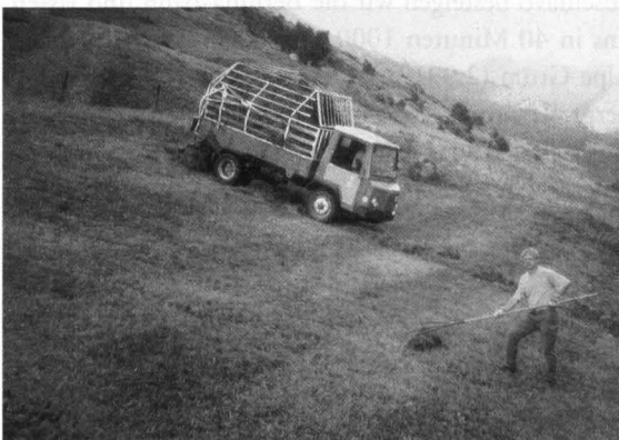
Auf den steilen Wiesen kann der Ladewagen wegen Kippgefahr nur senkrecht zum Hang fahren.
