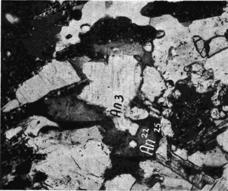
Abb. 23: Invers-zonare Oligoklas n -Rinde (An 22-25 ) um Albit n (An 3 ). Ge- kreuzte Nicols, etwa 120fache Vergrößerung.
