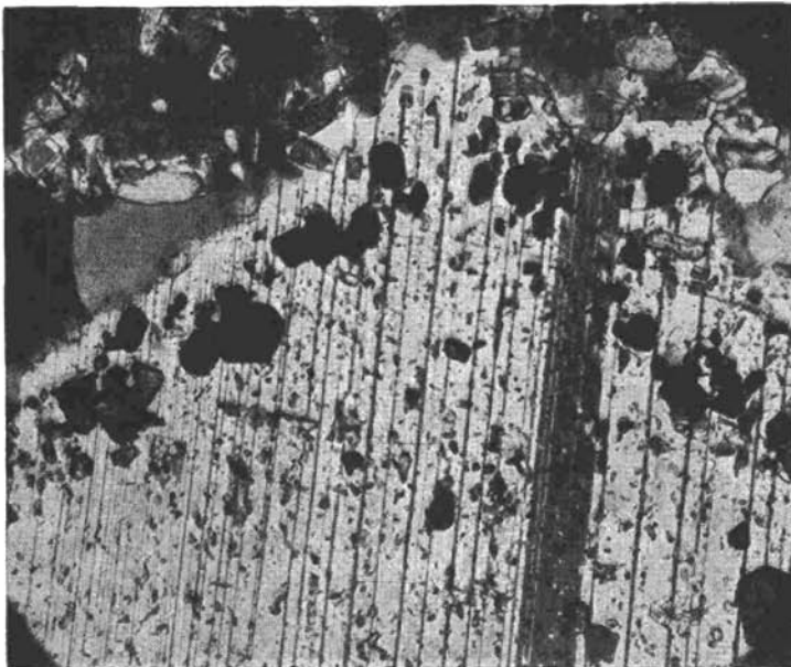
Abb. 30: Gefüllter Albit a mit Granatmikrolithenzone an der Grenze gegen ungefüllten Albit n . Schräge Nicols, etwa 200fache Vergrößerung.
