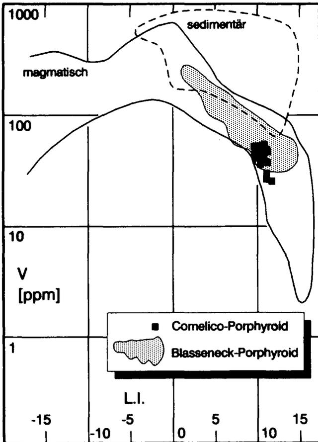
Abb. 6. Diagramm zur Unterscheidung von Gneisen magmatischer und sedimentärer Herkunft nach SHAW (1972). V = Vanadium-Gehalt in ppm, L.I. = Larsen-Index =  $\text{SiO}_2/3 + \text{K}_2\text{O} - \text{CaO} - \text{MgO}$  in Gew.-%. Eingetragen sind Werte des Comelico-Porphryoids und zum Vergleich dazu Werte des Blasseneck-Porphryoids nach KRETZSCHMAR (1989).
