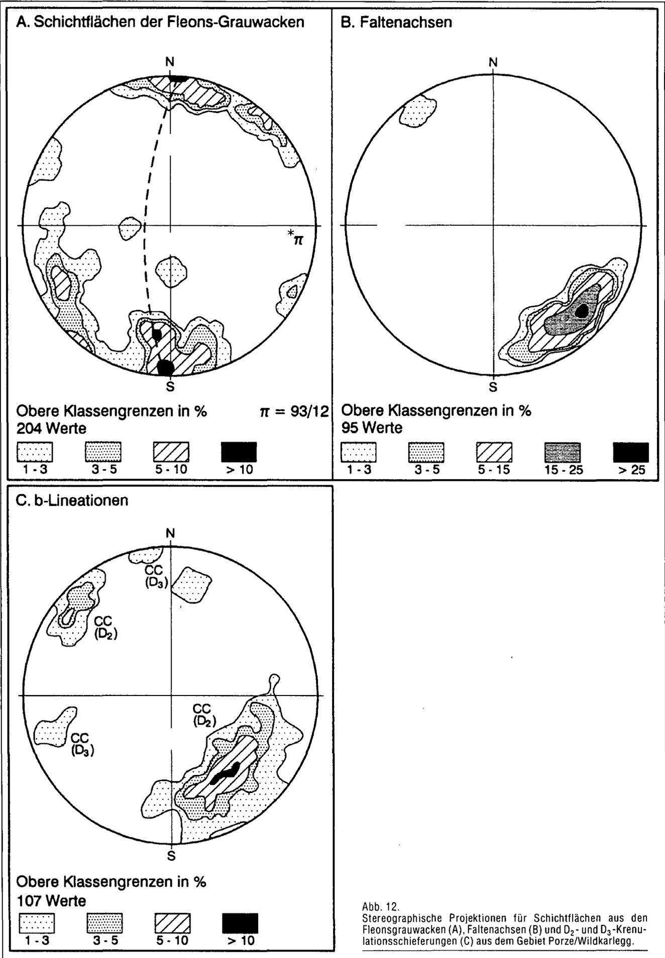
Abb. 12. Stereographische Projektionen für Schichtflächen aus den Fleonsgrauwacken (A), Faltenachsen (B) und D<sub>2</sub>- und D<sub>3</sub>-Krenulationschieferungen (C) aus dem Gebiet Porze/Wildkarlegg.
