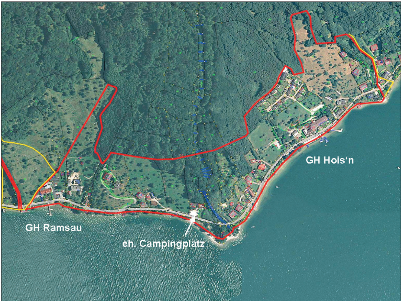
Abb. 9. Die Ausdehnung der „Roten Gefahrenzone“ über den seenahen Bereich des Gschlifgraben-Schuttkegels. Die Abbildung wurde freundlicherweise von der WLV, Sektion Linz, zur Verfügung gestellt).
