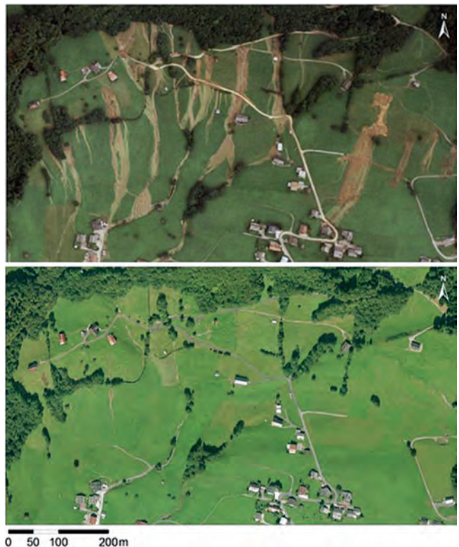
Abb. 5. Hangmuren im Bereich Berbigen/Vorsäß (Bregenzerwald). Mittels des zeitnahen Luftbildes sind die im August 2005 entstandenen Prozessbereiche und Standortverhältnisse im Abrissbereich der Hangmuren gut sichtbar (oben), während diese mittels eines Luftbildes von 2006 nicht mehr sichtbar bzw. identifizierbar sind (unten). Quelle der Luftbilder: WMS-Service der Vorarlberger Landesregierung.
