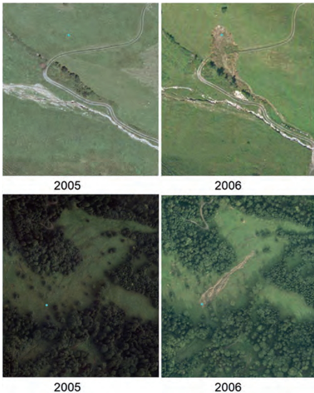
Abb. 19. Vergleich der Luftbilder von 2005 (links) und 2006 (rechts) und dadurch identifizierte Prozesse, die erst nach dem Datum des Luftbildes von 2005 entstanden sind. Es handelt sich somit um Prozesse, die potenziell nicht aufgrund des Niederschlagsereignisses entstanden sind, die zur überregionalen Katastrophe im August 2005 führten. Abbildungen oben: Im Bereich Ahornvorsäß westlich von Au; Abbildungen unten: Im Bereich der Gopfalpe südlich Reuthe. Quelle der Luftbilder: WMS-Service der Vorarlberger Landesregierung.
