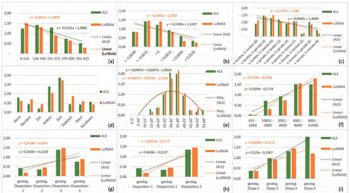
Abb. 17. Instabilitätsindex des ALS- und Luftbild-Prozessdatensatzes bezüglich der Parameterkarte Wald-dichte (a), Vertikalwölbung (b), Wölbungsklassifikation (c), Exposition (d), Hangneigung (e), Fließakkumulation (f), GGD I – 4 Klassen (g), GGD I – 3 Klassen (h), GGD II (i).
