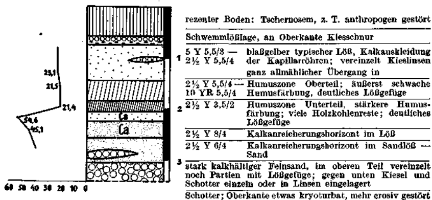
Abb. 5. Schottergrube Mannswörth-Reichsstraße (Punkt 15), Profil aus Wandabschnitt A
