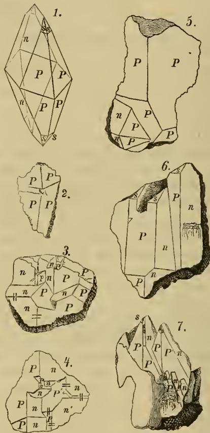
Figur 2 zeigt vier Flächen, welche in vier Kanten aneinander stoßen. Die beiden in der Figur vertikal gestellten Kanten messen  $106^{\circ}$ , die beiden horizontalen  $143^{\circ}$ , und dürfte es nicht zweifelhaft sein, dass die vier Flächen dem Oktaëder P angehören.
