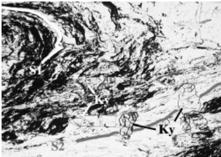
Abb. 3: Dünnschliffbild der Probe K17 von Kaisersberg. Ein älteres S1 Flächengefüge (helle Muskovit- und dunkle Graphitlagen) wird von B2 verfault, wobei Muskovit entlang der neuen S2 Achsenflächenschieferung eingeregelt wird. Die Kristallisation von *Kyanit*, sie wird der maximalen Metamorphose zugeordnet, ist als syn- bis post-D2 einzustufen. Bildbreite ca. 2 mm.
