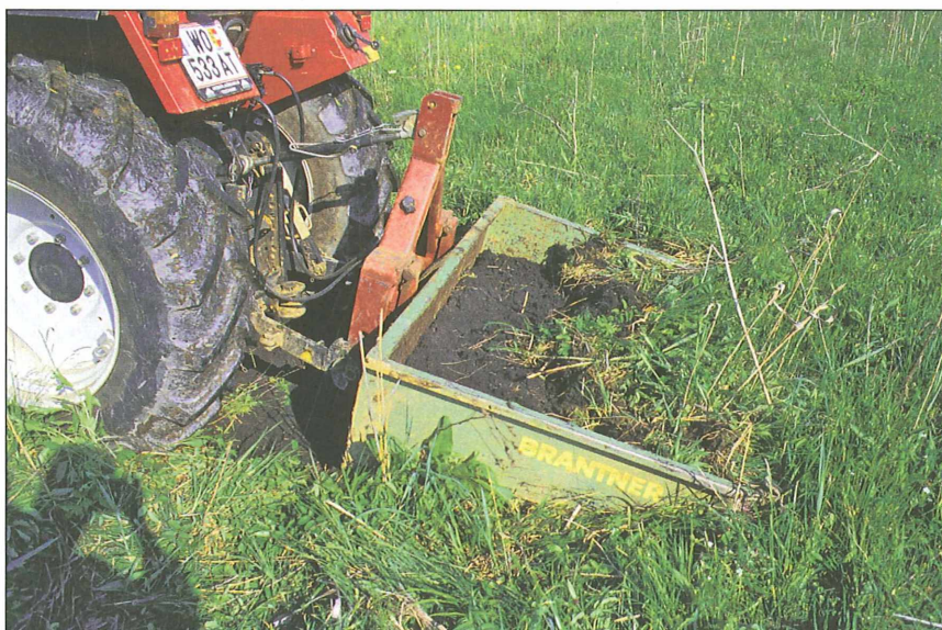
Abb. 2: Ein Teil der Feuchtwiese wird mit einer Heckschaufel vorsichtig abgetragen. (Foto: Krainer/Arge NATURSCHUTZ)
