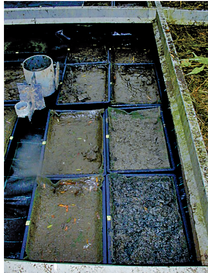
Abb. 5.1-3: Kaltbeete mit den Sedimentationsmatten in Plastikschalen, Freilandanlage Ökologiezentrum Kiel.
