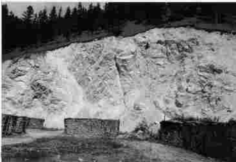
Abb. 41: Steinbruch Gräth. Die aufgeschlossenen Dachsteinkalke sind meist massig, durch tektonische Auflösung Zerfall in cm-große Bruchstücke.
