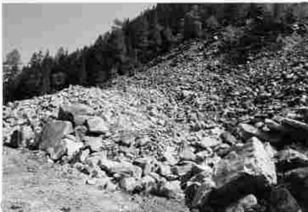
Abb.9: Das im Steinbruch Obertal 1237/1 gewonnene Material, Hangschutt aus Granitgneis, ist aufgrund seiner Blockgröße als Bau-, Dekor- und Wasserbaustein einzusetzen.
