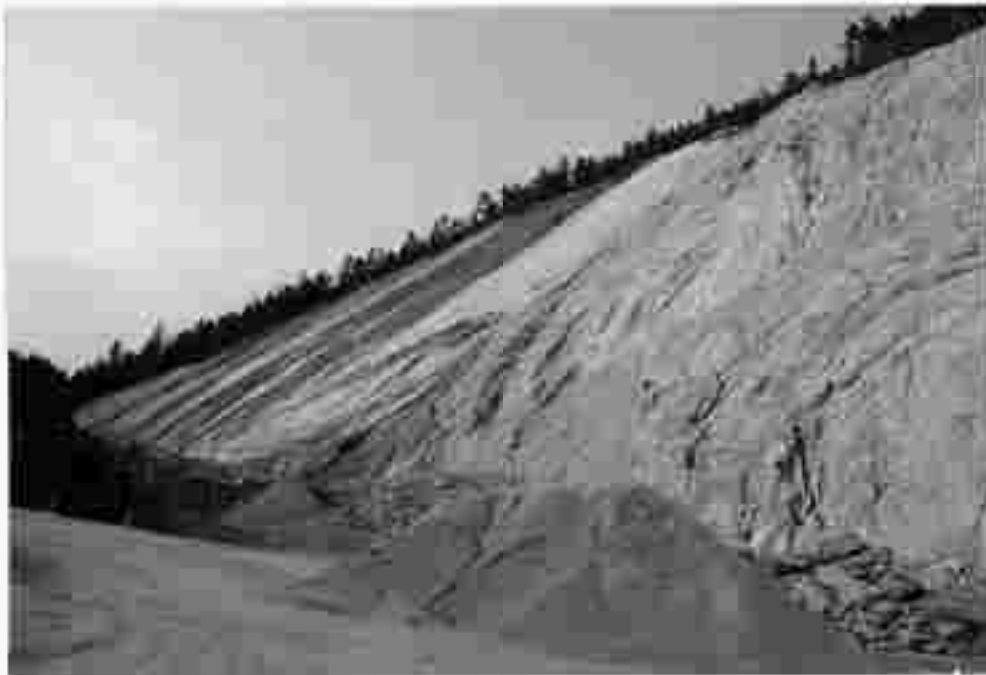
Abb. 21: Steinbruch Arzberger/Rottalberg 0730/1. Plattige bis bankige Quarzite. Verwendung als Straßenbaumaterial.
