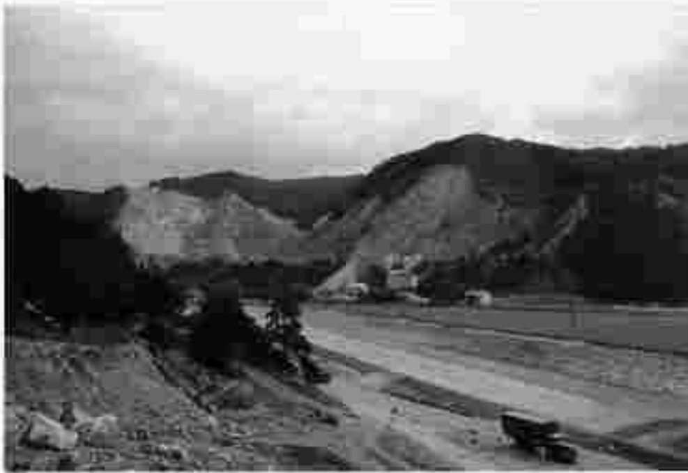
Abb. 15: Hartsteinwerke Preg 0910/1. Dickbankige Serpentinite im Etagenbau gewonnen.
