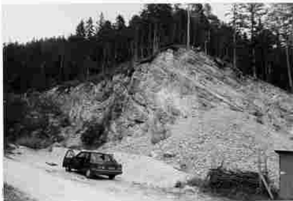
Abb. 8: Quarzitbruch Rettenegg - Ziegerhofer 1743/3. Das hier gewonnene und in ausreichenden Vorräten vorliegende Material eignet sich bestens zum Straßen- und Wegebau.
