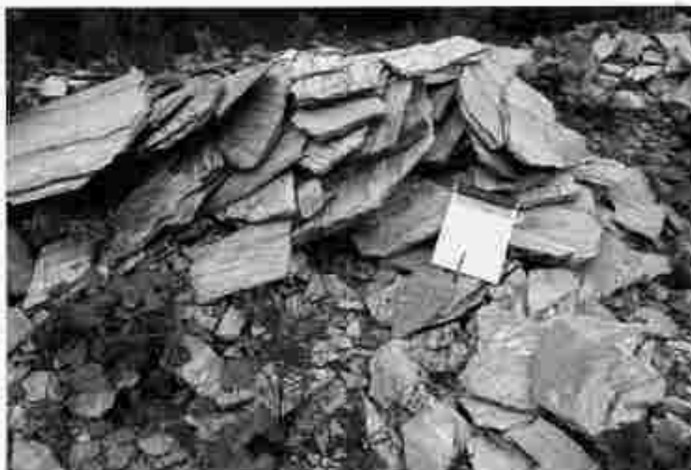
Abb. 32: Steinbruch Schifferl, 0307/2. Plattengneis, Bruchverhalten.
