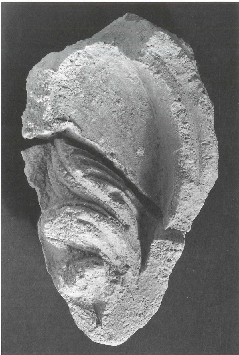
Abb. 1a u. 1b (rechts) Hohensalzburg, Kapelle, Grabung Salzburger Museum CA 1994, Stuckfragment 12. Jh. (?) aus hochgebranntem Gips. Fragmentansicht (1a) und Analysenbild (1b) einer Mikroprobe im Rasterelektronenmikroskop, die reinen, hochgebrannten Gips mit natürlichen Verunreinigungen (helle Punkte = Strontiumsulfat und zersetzter Pyrit) und ausreagiertem Kalk in der Randphase zeigt.
