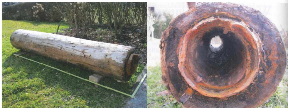
Abb. 2: Teuchel – Bauteillänge des Holzrohres ursprünglich rund 3 Meter, stirnseitig mit eingeschlagener Metalhülse 4 zur Herstellung einer dichten Verbindung mit der Anschlussröhre
