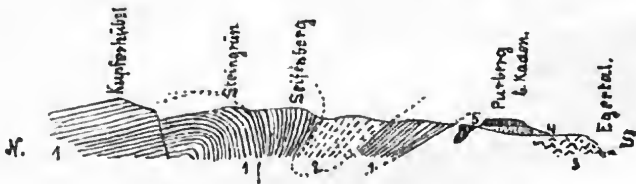
Abb. 114. Vom Kupferberg zum Egertal bei Tschernitz (n. Laube). 1. Gneis. 2. Glimmerschiefer. 3. Granulit. 4. Basaltuff. 5. Basalt.
