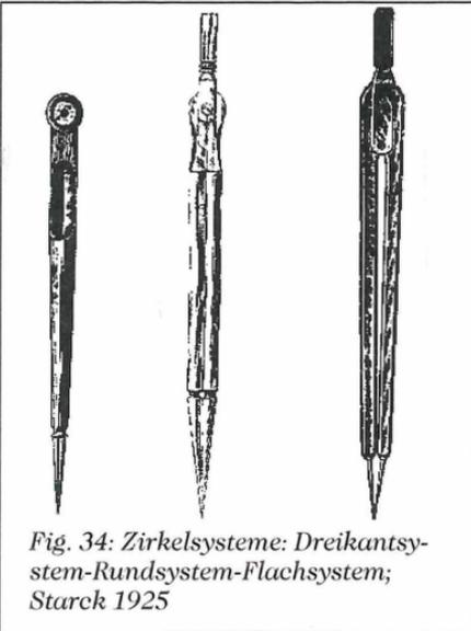
Fig. 34: Zirkelsysteme: Dreikantsystem-Rundsystem-Flachsystem; Starck 1925
