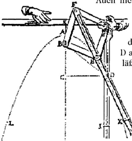
Fig. 48: Parabelzeichninstrument nach Frans van Schooten
