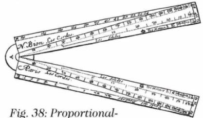
Fig. 38: Proportionalzirkel; N. Bion: *Traité de la construction et des principaux usages des instruments de mathématique*, Paris 1752
