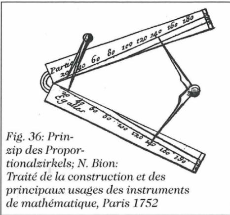
Fig. 36: Prinzip des Proportionalzirkels; N. Bion: *Traité de la construction et des principaux usages des instruments de mathématique*, Paris 1752
