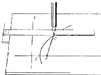
Fig. 42: Fadenkonstruktion der Parabel nach Lietzmann, 1949, S. 90
