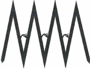
Fig. 16: Längenmessung durch Abschlagen
