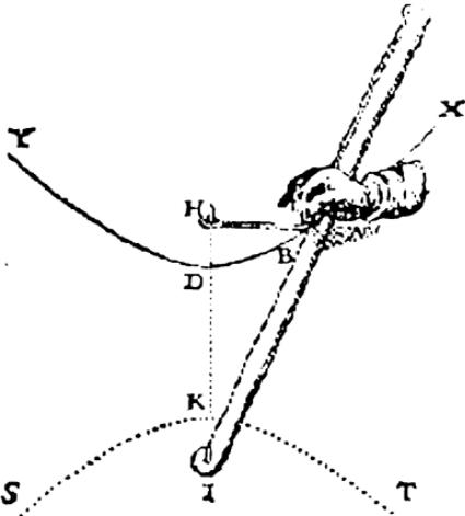
Fig. 44: Fadenkonstruktion der Hyperbel nach Descartes
