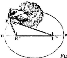
Fig. 41: Fadenkonstruktion der Ellipse nach Descartes, 1637, S.90
