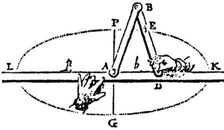
Fig. 46: Ellipsenzeichninstrument nach Frans von Schooten
