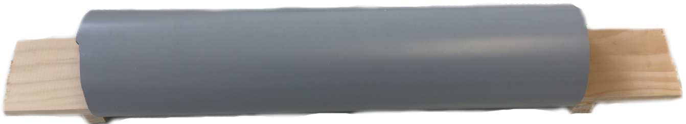
Abb. 1: Aufbau eines Spurentunnels aus Plastikrohr und Holzschieber.
