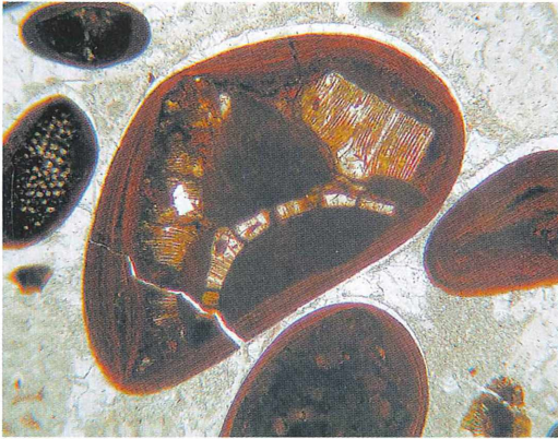
Abb. 6: Fossilbruchstücke als Kerne von Limonit-Ooiden in Kalkstein. Fast der gesamte Limonit-Anteil des Gesteins ist an derartige geschichtete Körner oder Bruchstücke davon gebunden; die Matrix des Gesteins ist frei davon. Die Körner liegen jedoch so dicht, dass der Eisengehalt des Gesteins hoch genug war, um es als Erz abzubauen und zu verhütten.
