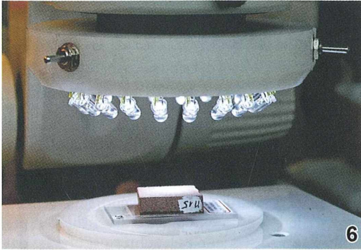
Abb. 5: LED-Ring für Auflicht mit eingebautem Objektiv. – Abb. 6: Auflicht-LED-Ring in Arbeitsposition.
