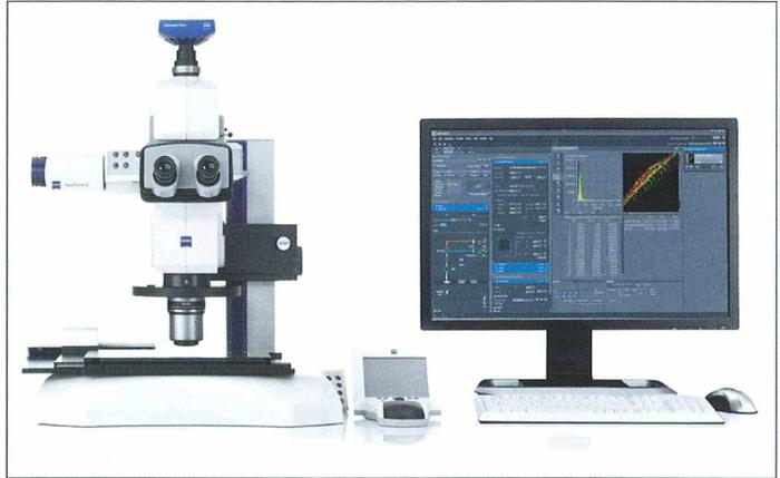
**Abb. 1:** Axio Zoom.V16 von Carl Zeiss mit ApoTome.2-Einbaueinheit für optische Schnitte.
