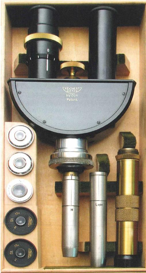
Abb. 6: Komplette binokulare Stereo-Aufsatz-Einrichtung im Transportbehältnis.
