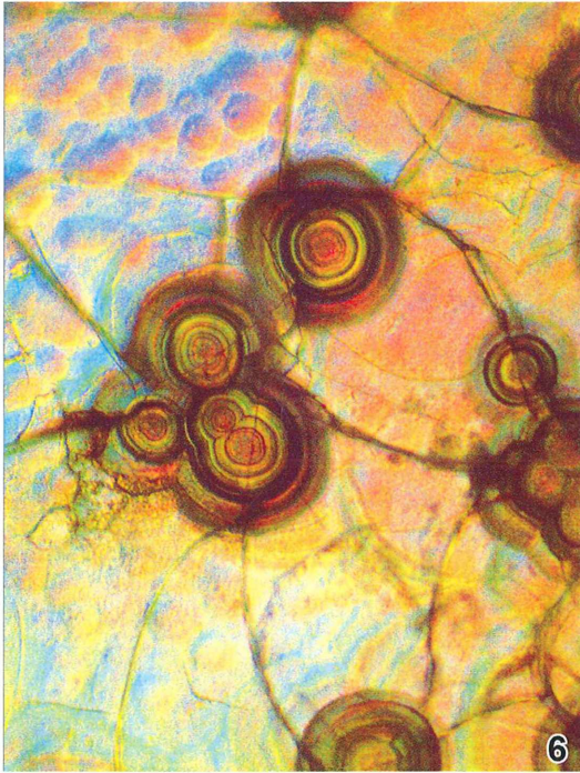
Abb. 6: Korrodierte Glasoberfläche mit feinen Rissen und ringförmigen Ausfällungen (Metalloxide?) mit wechselndem Konzentrationsgradienten (ähnlich Achat). Objektiv 16x, DIK. – Abb. 7: Ähnliches Objekt wie in Abbildung 2 bei stärkerer Vergrößerung und im Durchlicht. Markante Grenzen interferierender Bereiche zu nicht interferierenden weisen auf teilweise Absplitterung dünner Schichten hin.
