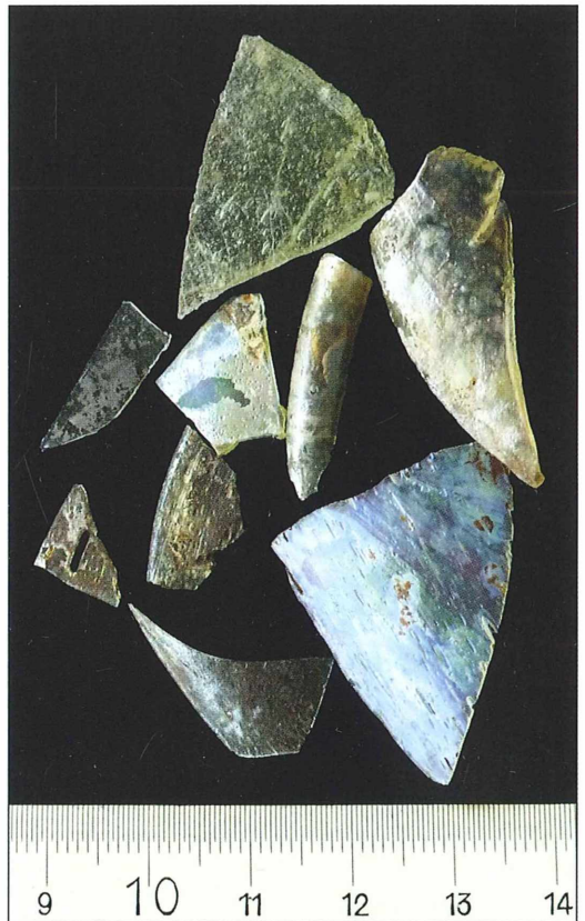
Abb. 1: Alte, stark korrodierte Glasscherben aus Side (Türkei).
