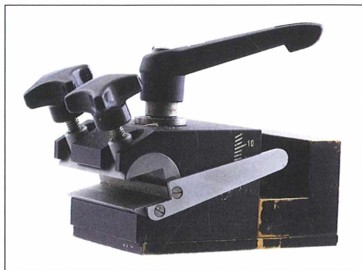
Abb. 8: Neaplerklemme des Jung HN-40 Schlittenmikrotoms mit Skala für die Einstellung von Freiwinkel/Inklination.
