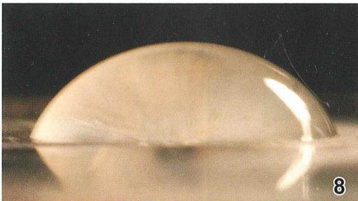
Abb. 7: Der Fichtenzapfenrübling ( Strobilurus esculentus , Blätterpilz). – Abb. 8: Ein auf dem hydrophilen Sporenteppich von S. esculentus abgesetzter Wassertropfen läuft breit aus. Der Kontaktwinkel beträgt ca. 57^\circ .
