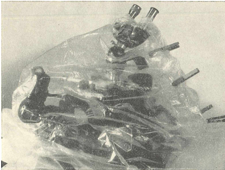
Abb. 4: Die Anordnung im Betrieb. Der Plastiksack umgibt alle Geräte und ist durch Klammern geschlossen. Nur die Okularstützen ragen heraus
