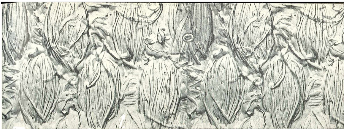
Übersicht über 2 x 3 Ketten eines Regenmantelstoffes (Ninoflex); ROX-UG-Negativ unbedeckt, schräg beleuchtet. Aufn.: H. REUMUTH (aus Melliland Textilberichte 36, 533—539, 1955)
