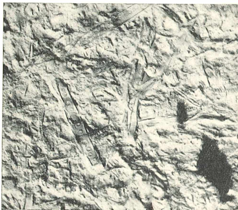
Abb. 5: Abdruck eines Schreibpapiers in ROX-UG. An den Zellulose-Fasern sind sogar die einzelnen Hoftüpfel abgeformt. Aufnahme im Hellfeld-Schrägl. H. REUMUTH
