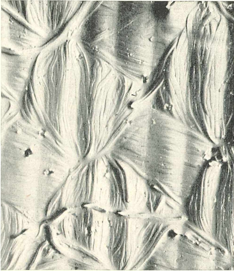
Abb. 6: ROX-UG-Gewebeabdruck eines Zellwollgewebes mit einer Permanent-Ausrüstung vor dem Waschen. Aufn.: Verf.
