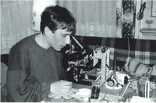
Abb. 7: Mikroskopieren mit der von BONITO aus einem Metall-Baukasten gefertigten primitiven Vorrichtung für Beleuchtung und Einblendung eines Elektronen-Blitzes, der – oben auf das Gestell gelegt – sein Licht über eine Glasscheibe in den Strahlengang schickt.
