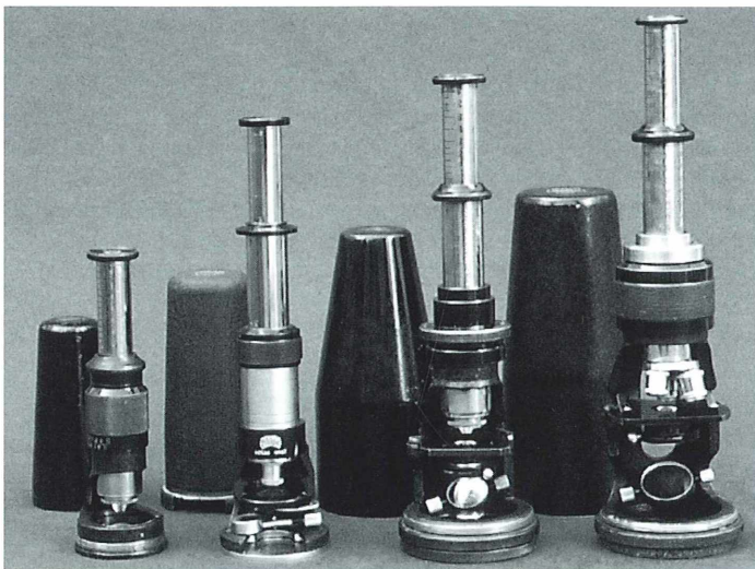
Abb. 3: Die Taschenmikroskop-Produktpalette der Firma Hensoldt & Söhne (von rechts nach links): zwei Versionen des Tami, das Metami sowie das Protami mit dazugehörigen Metall-schutzhülsen. Zu den Geräten wurde eine reichhaltige Auswahl von Zubehör und Nebenapparaten angeboten wie zum Beispiel elektrische Beleuchtung, Dunkelfeldkondensor, Polarisationsapparat, Kreuz- und Drehtische, Insektentisch, Zeichen- und Projektionsapparate sowie Binokulartubus (Foto: G. Teichert, Berlin).
