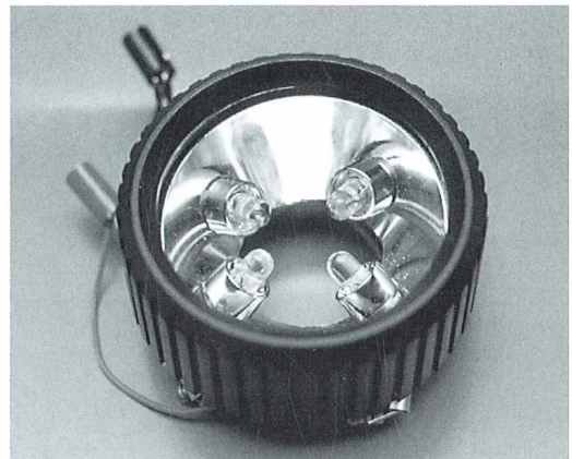
Abb. 5: Unterseite einer Auflicht-Dunkelfeldbeleuchtung mit vier LEDs, Parabolspiegel einer Taschenlampe als Grundlage.
